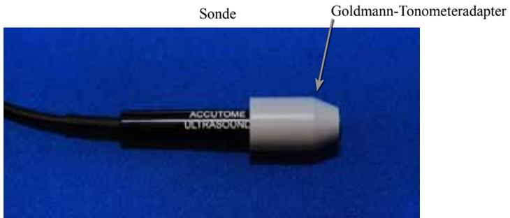
**Abb. 3-6** Sonde mit Goldmann-Tonometeradapter
